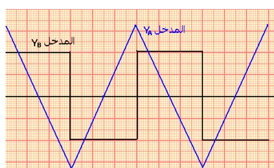
I - نغذي دارة كهربائية تتوفّر على مكثف سعته  $C=0,33mF$  مركب على التوالي مع موصل أومي مقاومته  $R=3,0\Omega$  بواسطة مولد ذي توترات مربعة  $E=6,0V$  دورها  $T$  و دورها  $t=0$  قاطع التيار مغلق و يكون المكثف بدئياً مفرغاً.
