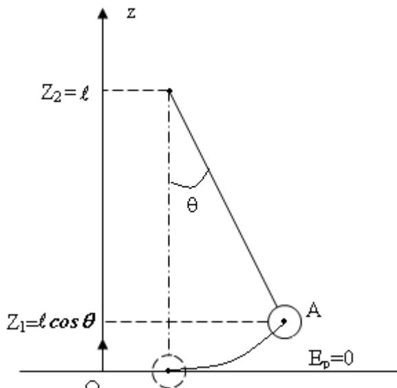
ب - تعبير الدور  $T_0$  لهذا النواس :  $T_0 = 2\pi \sqrt{\frac{\ell}{g}}$
