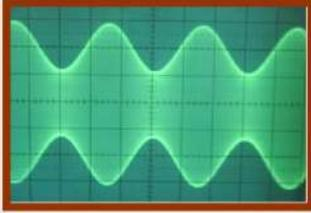
ب- نضبط زر الكسح على النظام Y-X فنحصل على الشكل التالي:
