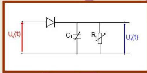
يمثل  $u_s(t)$  توتر الخروج بالنسبة للدارة المتكاملة المنجزة للجداء. نضبط  $R_1$  و  $C_1$  على القيم  $C_1 = 47nF$  و  $R_1 = 10K\Omega$ .
