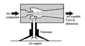
L'air comprimé, en passant rapidement dans le venturi, provoque à cet endroit une dépression et entraîne avec lui l'air présent dans le conduit perpendiculaire.
