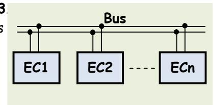
Il est évident que pour qu'une communication soit possible, il faut que chaque EC dispose d'une interface pour le Bus, plus précisément la possibilité de se mettre en haute impédance, ainsi, on évite les conflits de Bus, cas où 2 EC émettent sur le Bus.
