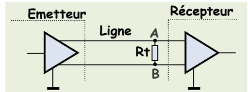
**R<sub>t</sub>** : Résistance de terminaison de câble. Elle boucle la ligne sur son impédance caractéristique et minimise le bruit pour une meilleure transmission.
