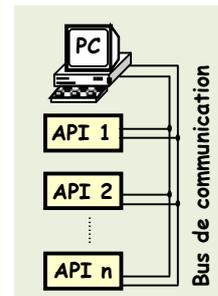
Il va sans dire que le **Bus** est partagé et doit donc connaître un "**arbitrage**", en effet, d'après la structure physique du réseau (**norme RS485**), il ne peut y avoir qu'un seul élément qui émet sur le bus, le reste écoute, d'où la nécessité de s'accorder sur des règles de communication, qu'on appelle **protocole**.
